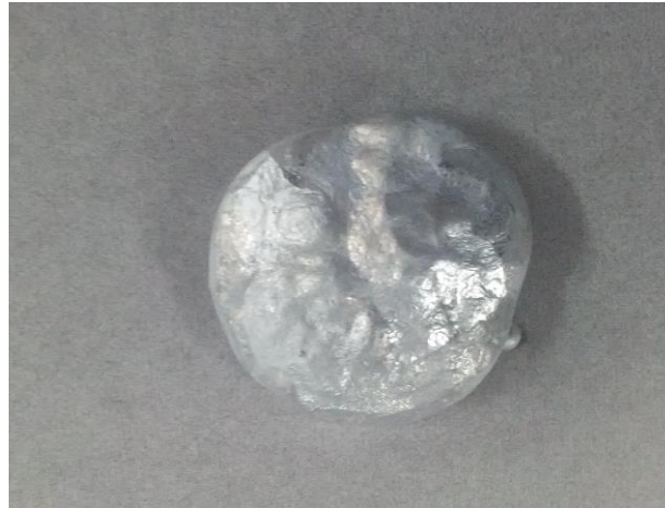
図 7. 電気分解によって得た高純度金属亜鉛
